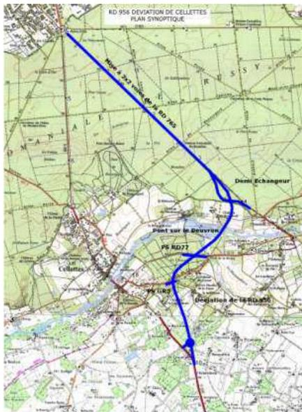
Les travaux se décomposent en 2 tronçons. Le premier a déjà été réalisé entre 2011 et 2012. Il s'agissait de la mise à 2x2 voies de la RD 765 du giratoire de la patte d'oie jusqu'au nord de Clénord (3,6 km). **Le deuxième tronçon correspond à la création d'une route nouvelle (3,4 km).**
